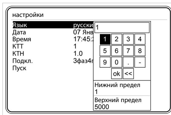
Рис. 3-5 Ввод коэффициента трансформации ТТ
