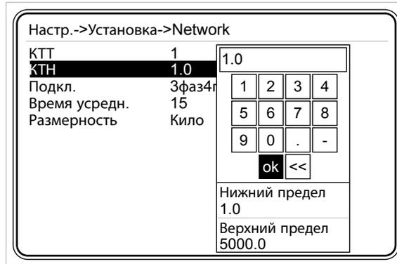
Рис. 3-15 Настройка коэффициента трансформации ТН
