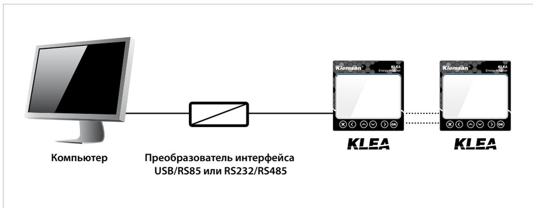
Рис. 4-2 Соединение ПК с анализатором KLEA по линии RS485
